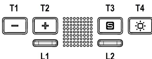
Za upravljanje funkcijama dovoljno je lagano dodirnuti simbole T1. OFF/smanjenje brzine (snage) usisa.
