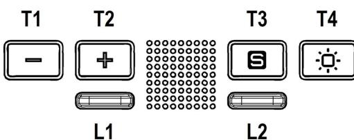
Pentru controlul funcțiilor este suficient să atingeți simbolurile T1. OFF/descrășterea vitezei (puterii) de aspirare.
